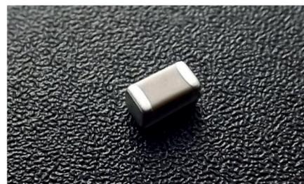
Capacitor de eletrodo de resina que suprime a deflexão de som e reduz o ruído.
