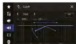
Display de ajuste do corte para HPF (Alto-falante frontal)
