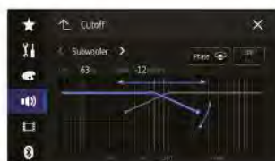
Display de ajuste do corte para LPF (Subwoofer)
